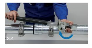
3.5 Nach Einhängen Der Kletterstange in die Spannbacken Typ A wird das Klettergetriebe unter Betätigung des Lösehebels mit dem Dorn (a) in die innere Bohrung der
