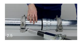
2.6 Klettergetriebe mit Dorn (a) in die äußere Bohrung der Spannbacken Typ B (b) einhängen. Das Klettergetriebe ist durch Drücken des Lösehebels leicht zu verschieben.
