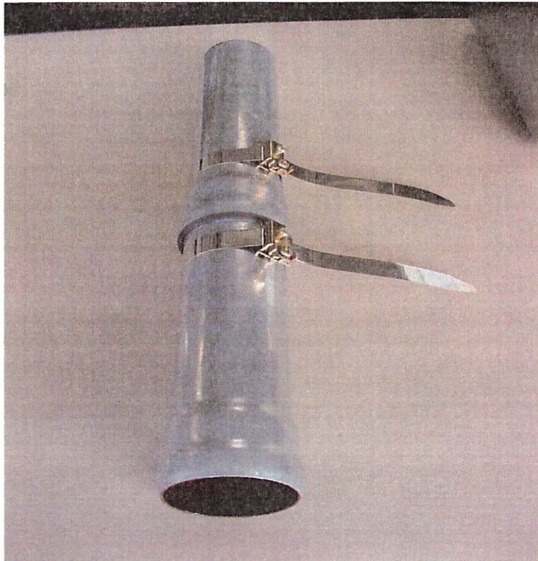
Bild 5: Rohrverbindung ohne Sicherungsschelle
