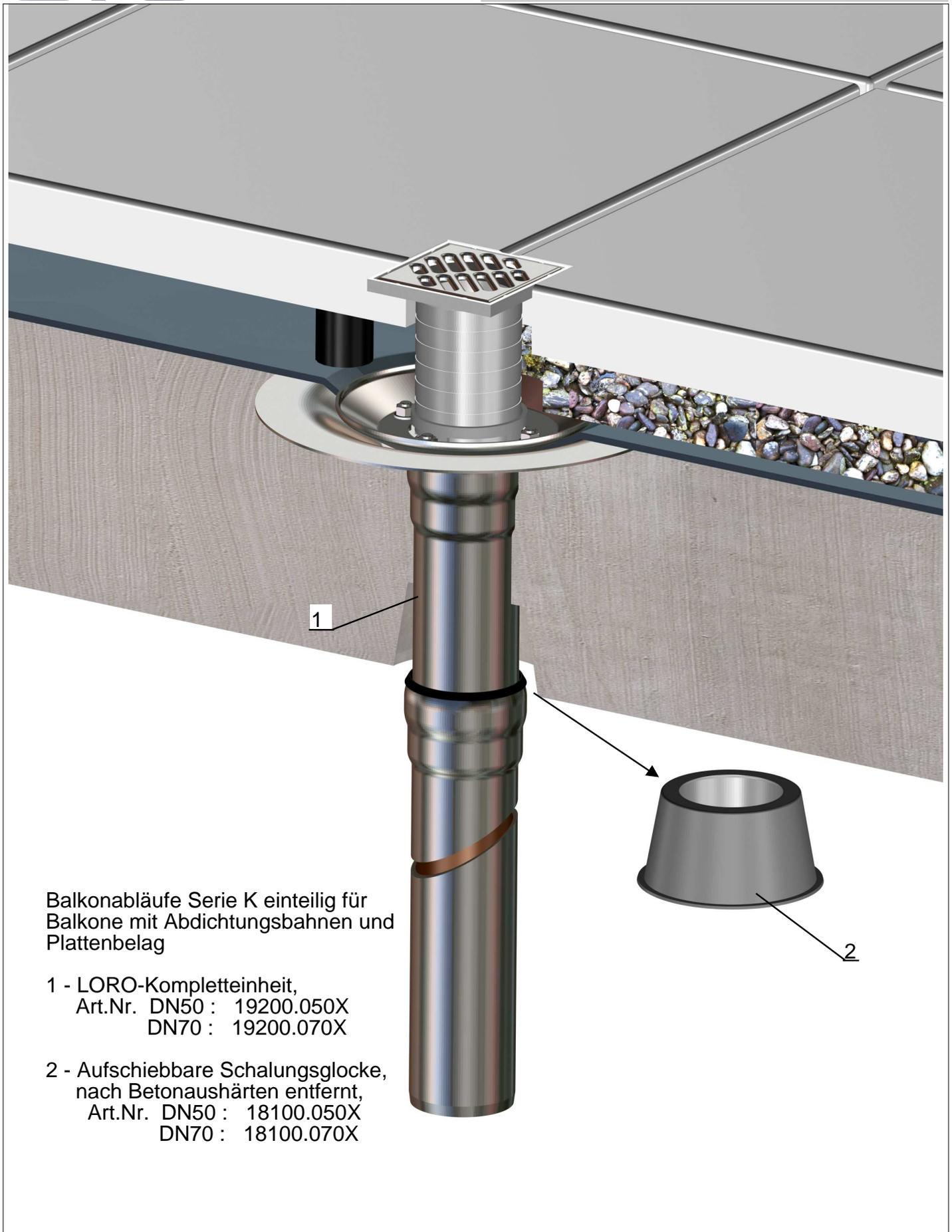
Balkonabläufe Serie K einteilig für Balkone mit Abdichtungsbahnen und Plattenbelag
