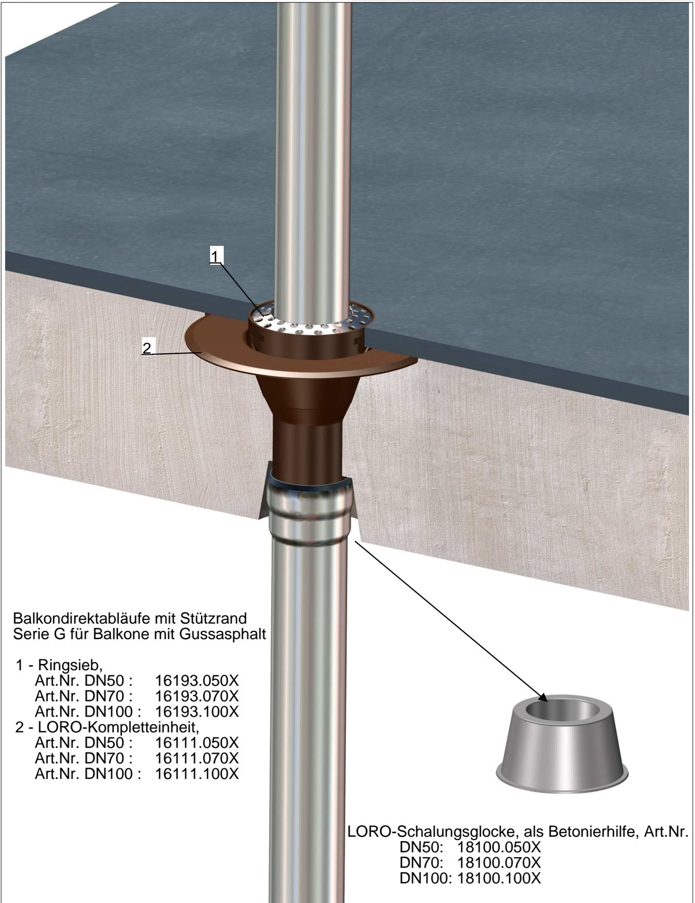
Balkondirektabläufe mit Stützrand
