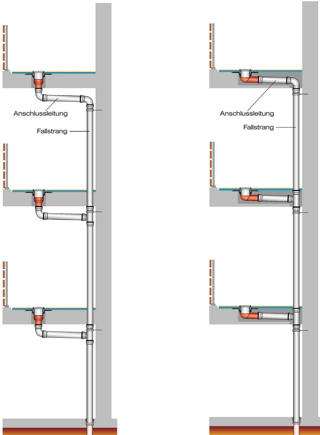
Balkonplatte mit Fliesenbelag im Klebebett, mit Flächenabdichtung aus Flüssigkunststoff, ohne Wärmedämmung. Entwässerung in einer Ebene.
