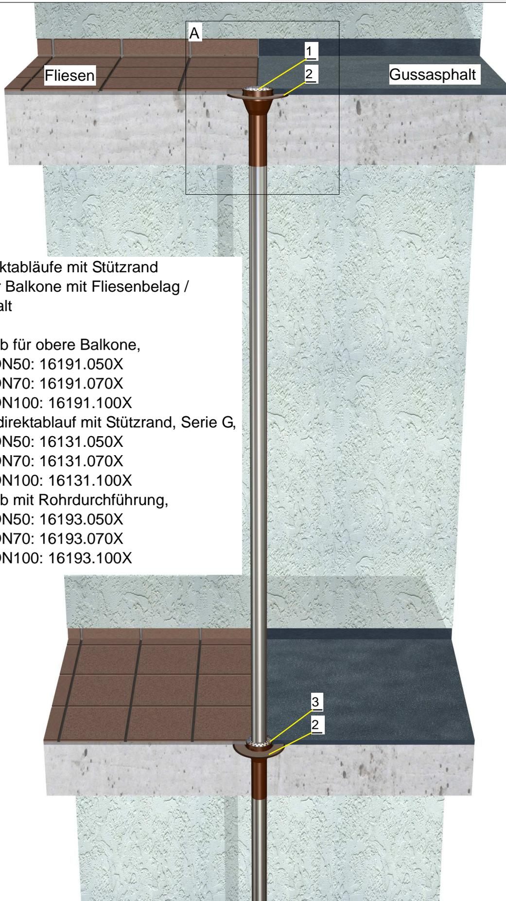
Balkondirektabläufe mit Stützrand
