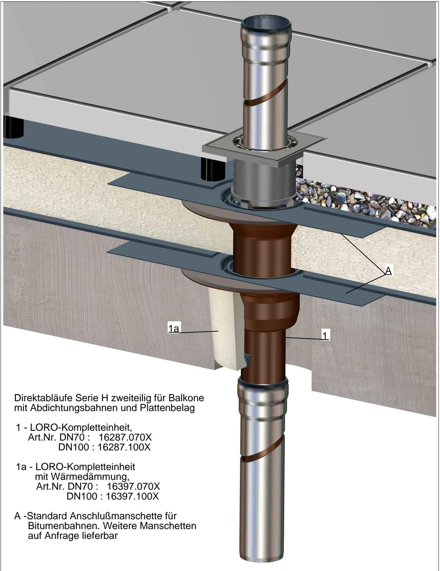
Direktabläufe Serie H zweiteilig für Balkone mit Abdichtungsbahnen und Plattenbelag
