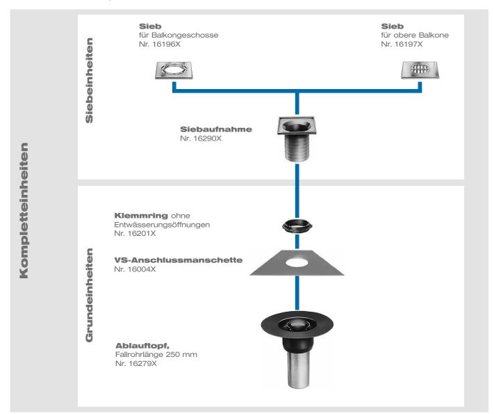
LORO-Direktabläufe, Serie HF, werden als Kompletteinheiten geliefert. Sie können aber auch alternativ aus Teileinheiten (Ablaufgrundeinheit, Siebeinheit) für den jeweiligen Einsatzfall zusammengesetzt werden. Auf Anfrage sind LORO-Direktabläufe, Serie HF, bei wärmegedämmten Decken auch mit Wärmedämmung und Etageneinsatz lieferbar. Sie können kombiniert eingesetzt werden z.B. Direktablauf mit Anschlussmanschette, Serie H, und Etageneinsatz mit VS-Anschlussmanschette.
