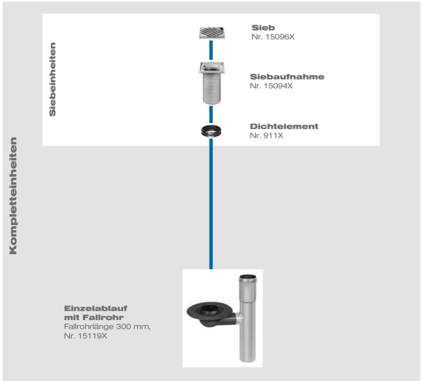
LORO-Balkonentwässerungseinheiten, Serie BE, werden als Kompletteinheiten geliefert. Sie können aber auch alternativ aus Teileinheiten (Siebeinheiten) oder aus Einzelteilen für den jeweiligen Einsatzfall zusammengesetzt werden.
