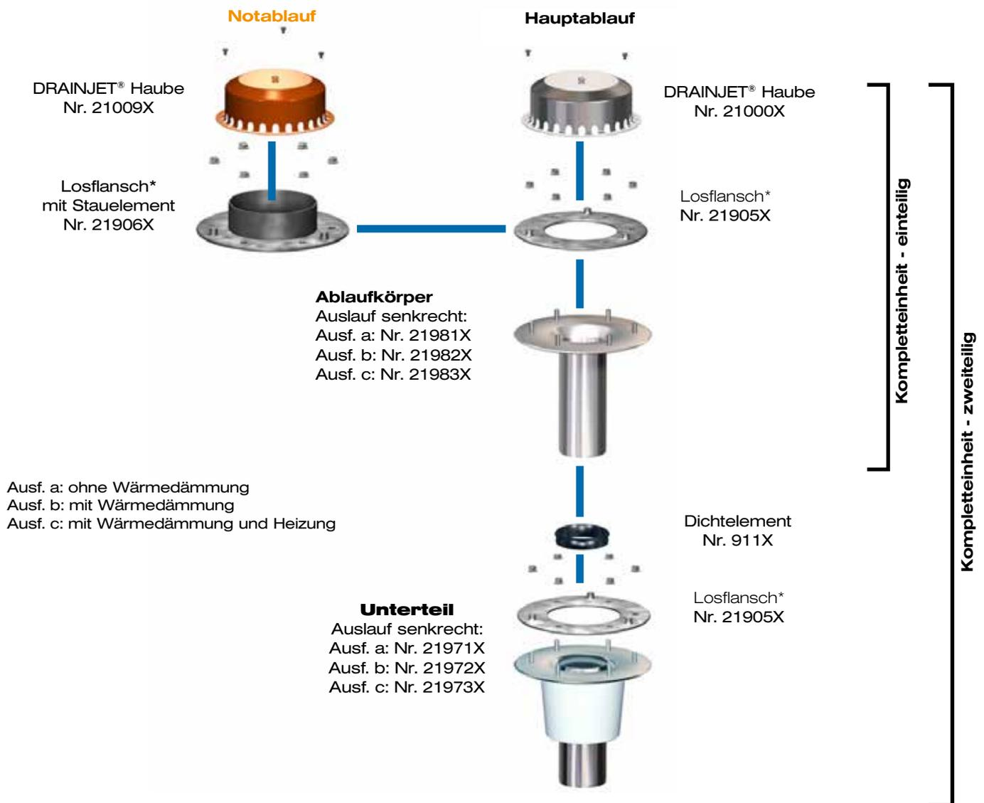
\* Einschließlich Kompressionsdichtung aus Perbunan, kann bei Verwendung von Bitumen-Dachdichtungsbahnen entfallen.
