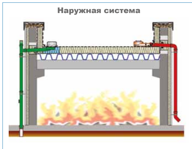
Автоматическая противопожарная защита без проведения трубопровода в противопожарной зоне
