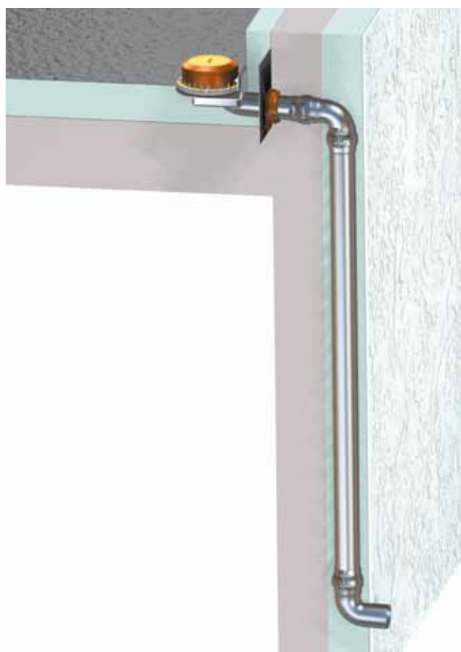
Аварийный водоотвод со стоком за пределы здания
