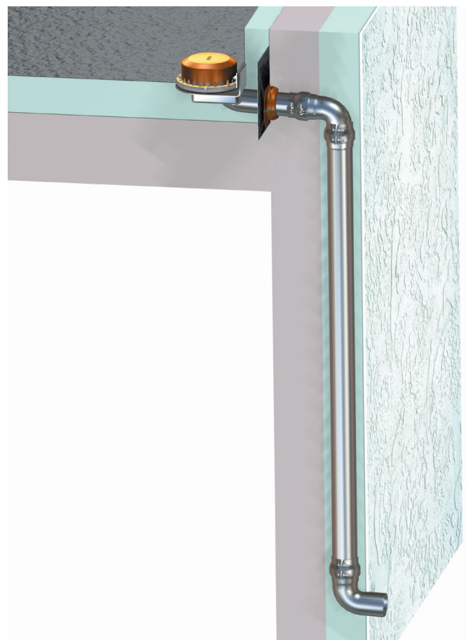
Notentwässerung mit Abfluss ins Freie
