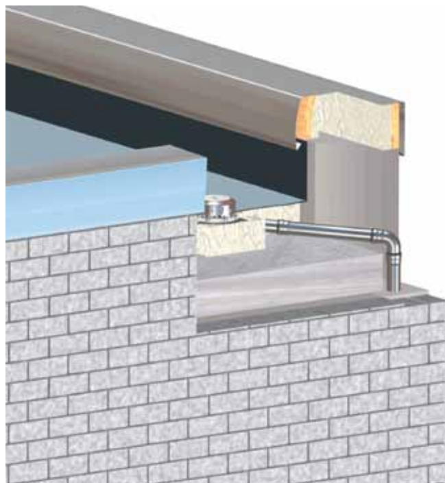
Hlavní odvod vody
