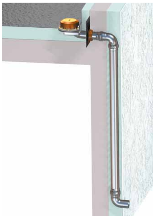
Nouzové odvodnění s odtokem ven
