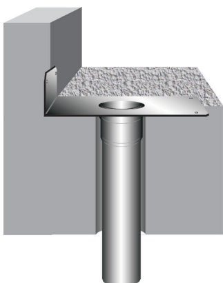
2.3 De afvoerpijp van het afvoerelement op de bouwplaats qua lengte aanpassen en in het boorgat plaatsen.
