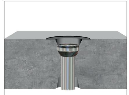
Schalungspilz und Schalung entfernen. Eingebauter ungedämmter Grundkörper fertig für weiteren Balkonaufbau und weiterführende Leitung.
