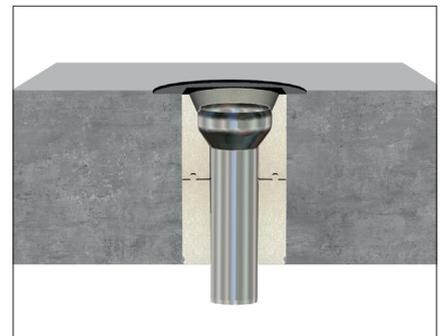
Schalungspilz und Schalung entfernen und Grundkörper Serie V in eingebauten Wärmedämmkörper einsetzen. Wärmedämmter Grundkörper fertig für weiteren Balkonaufbau und weiterführende Leitung.
