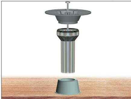
Grundkörper, Schalungspilz\* und Schalungsglocke ergeben im Zusammenbau die Stärke der Balkonplatte. Der Grundkörper ist dementsprechend abzulängen.
