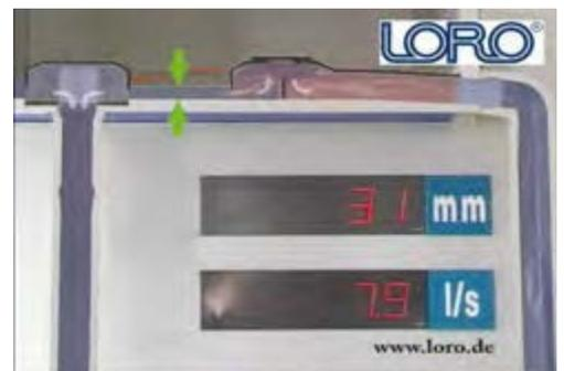
Stufe 3: Wasserhöhe auf dem Dach ist geringer als Wasserhöhe im Ablauf
