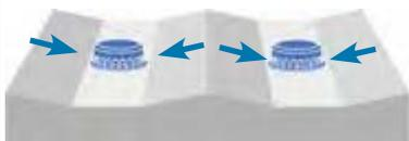
\* Hauptentwässerung:  $1000 \text{ (A in m}^2) \times (300/10\,000) \text{ l/s m}^2 \text{ (Regenspende in l/s m}^2 \text{ umgerechnet)} \times 0,5 \text{ (C)} = 15 \text{ l/s}$
