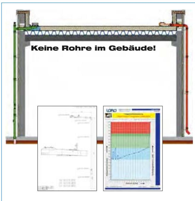
Vorgefertigte LORO-X Dachentwässerungssysteme für Attikadächer mit LORO-X Datenblatt
