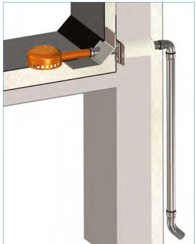
Vorgefertigte LORO-X Dachentwässerungssysteme
