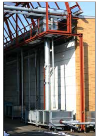
LORO-X-testfeltet med opptil 100 l/s avløp
