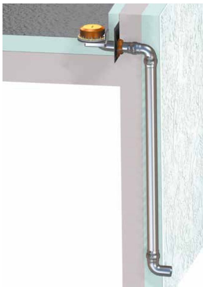
Nøddrenering med avløp ut i det fri
