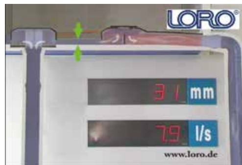
3. fokozat: A tetővíz magassága alacsonyabban van a lefolyóban lévő vízmagasságnál
