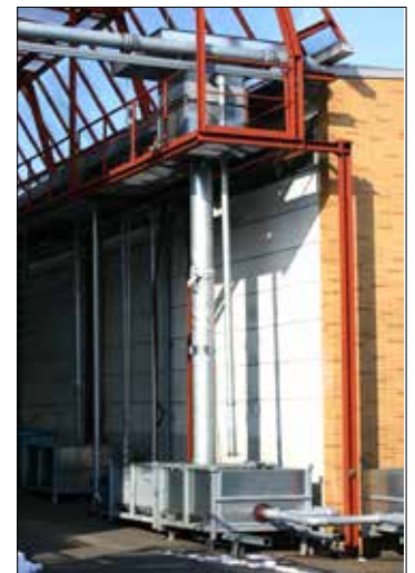
LORO-X prøvningskapacitet med op til 100 l/s afløb
