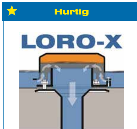
Fuld afløbsydelse ved minimal vandhøjde på taget.
