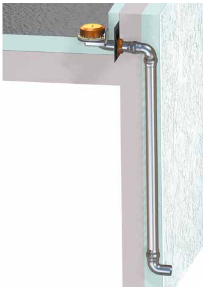
Notentwässerung mit Abfluss ins Freie
