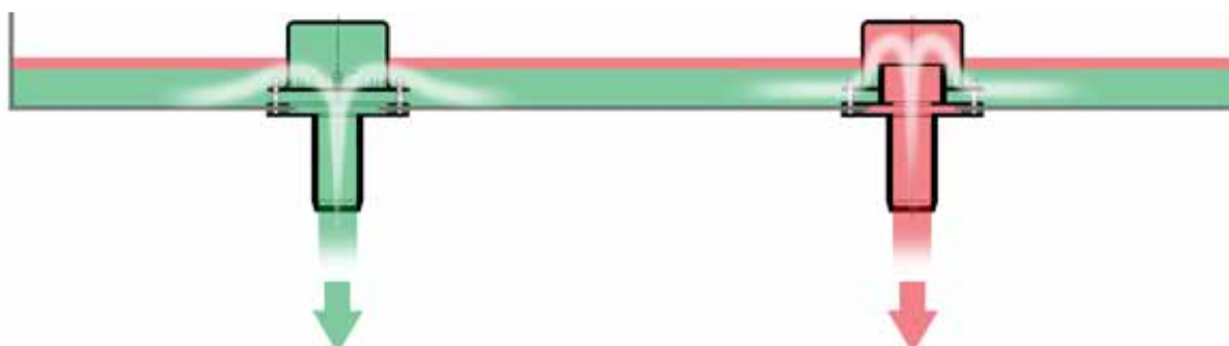
Hoofdafvoer met DRAINJET®-Mini
