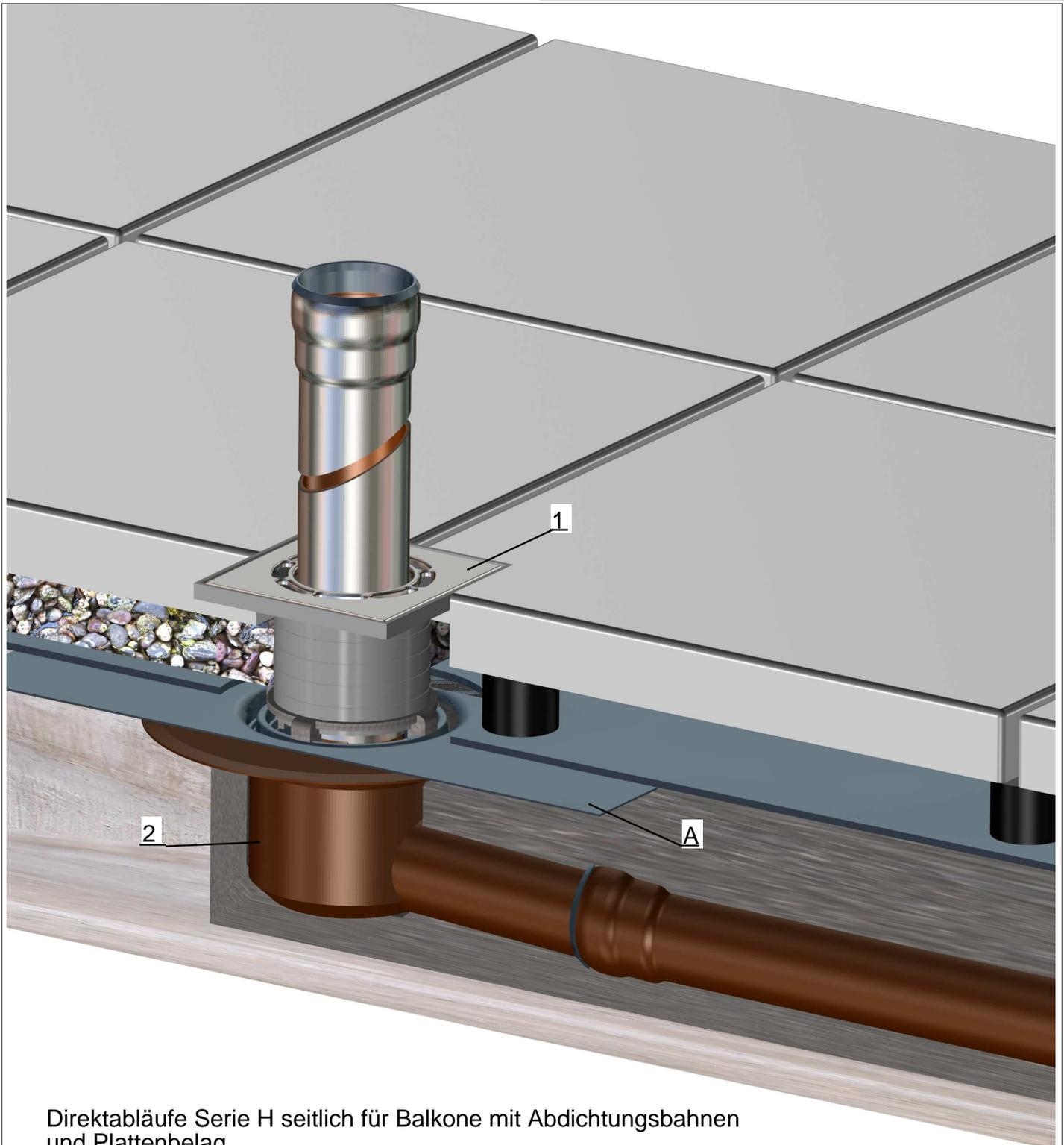
Direktabläufe Serie H seitlich für Balkone mit Abdichtungsbahnen und Plattenbelag
