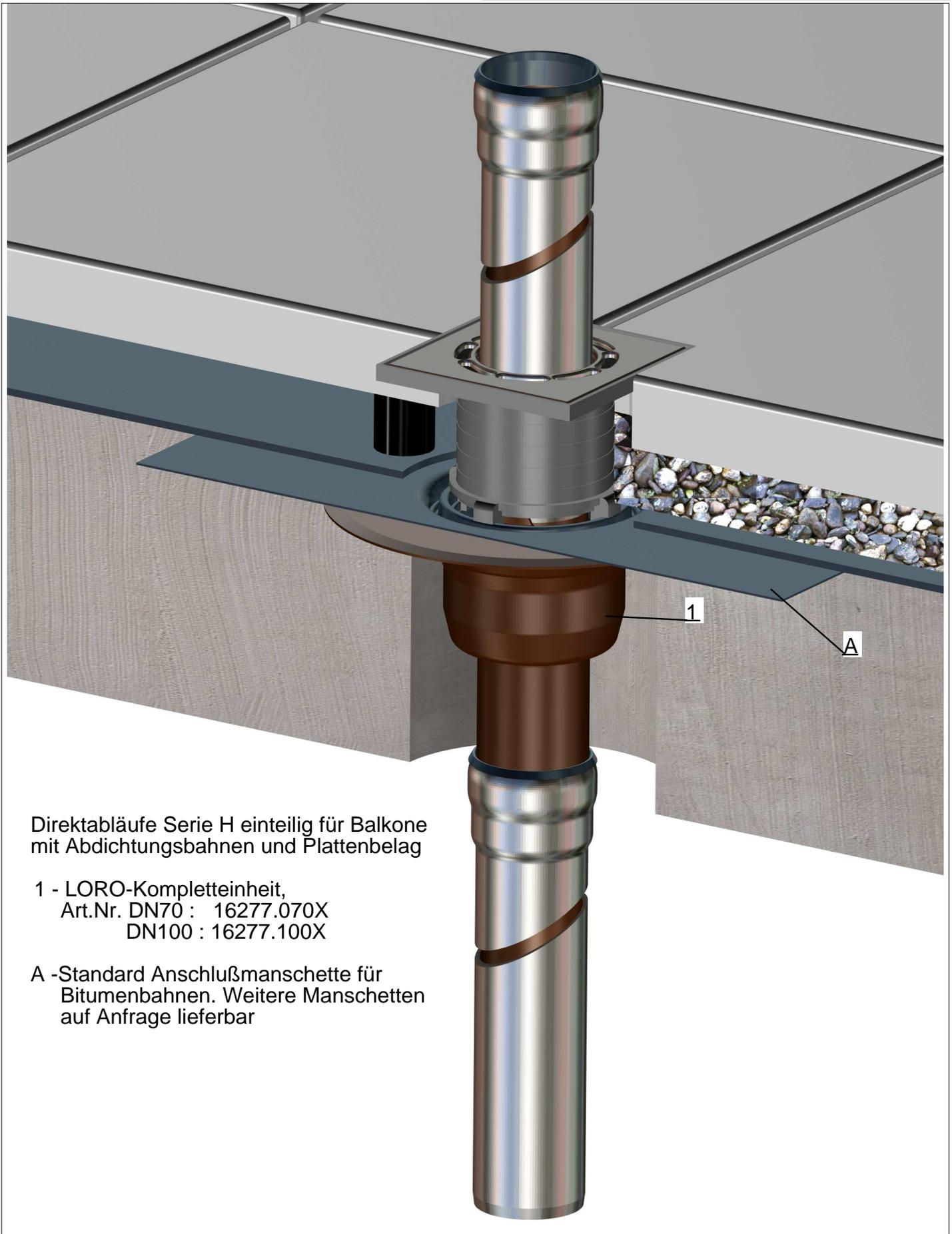
Direktabläufe Serie H einteilig für Balkone mit Abdichtungsbahnen und Plattenbelag
