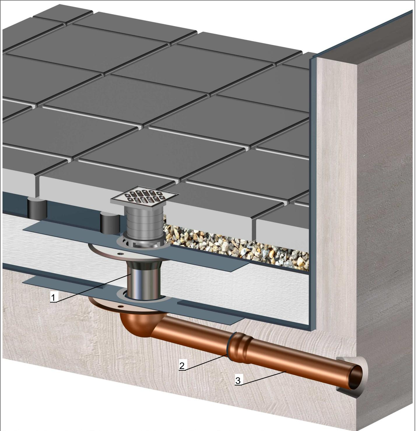
Balkonabläufe Serie F Auslauf seitlich zweiteilig für Balkone mit Wärmedämmung, Abdichtungsbahnen und Plattenbelag
