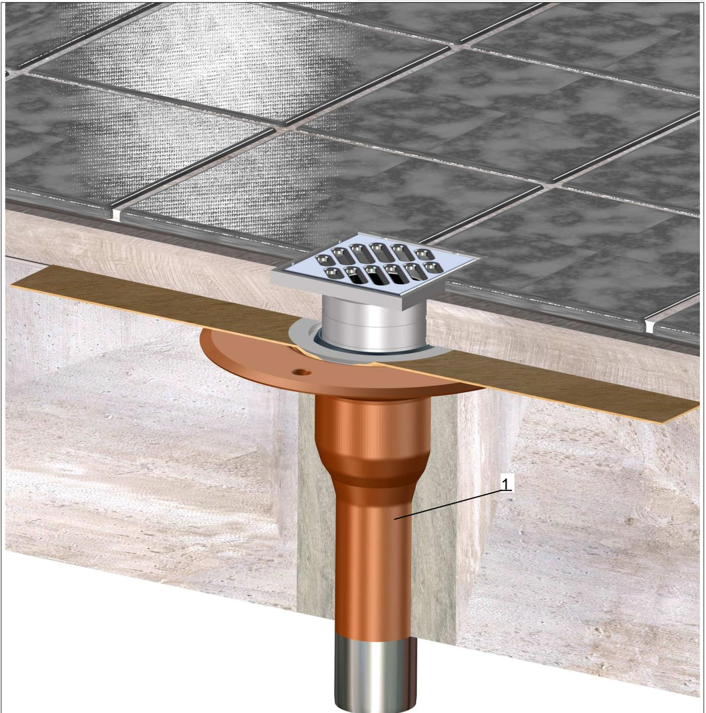
Balkonabläufe mit VS-Anschlussmanschette
