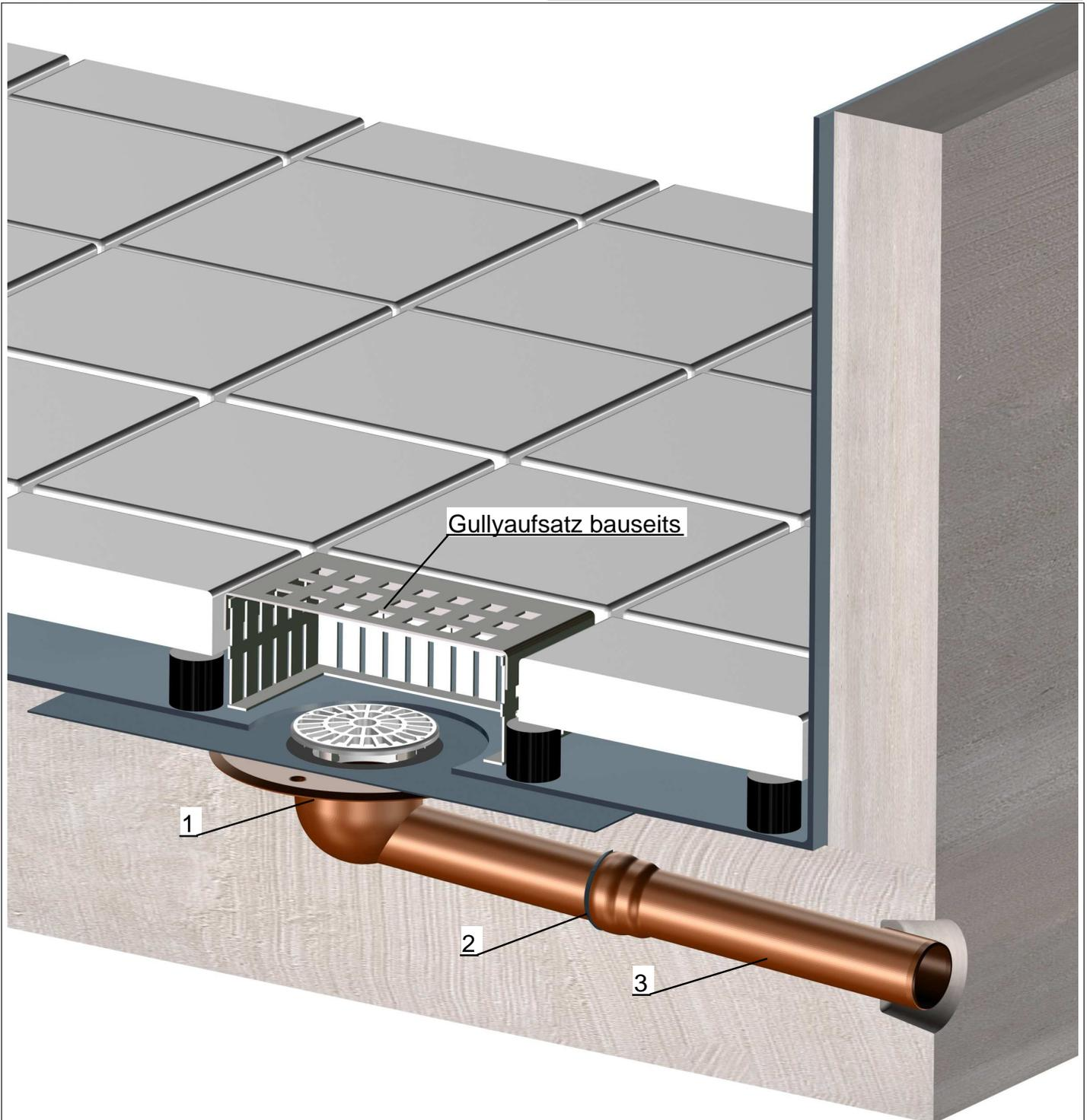
Balkonabläufe Serie E Auslauf seitlich für Balkone mit Abdichtungsbahnen und Plattenbelag
