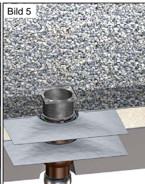
Bild 1: LORO-Balkondirektablauf Serie H für obere Balkone
