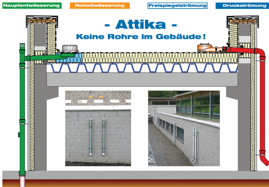
LORO-X Attika Dachentwässerungssysteme aus Stahlabflussrohr mit LORO-X Steckmuffenverbindung
