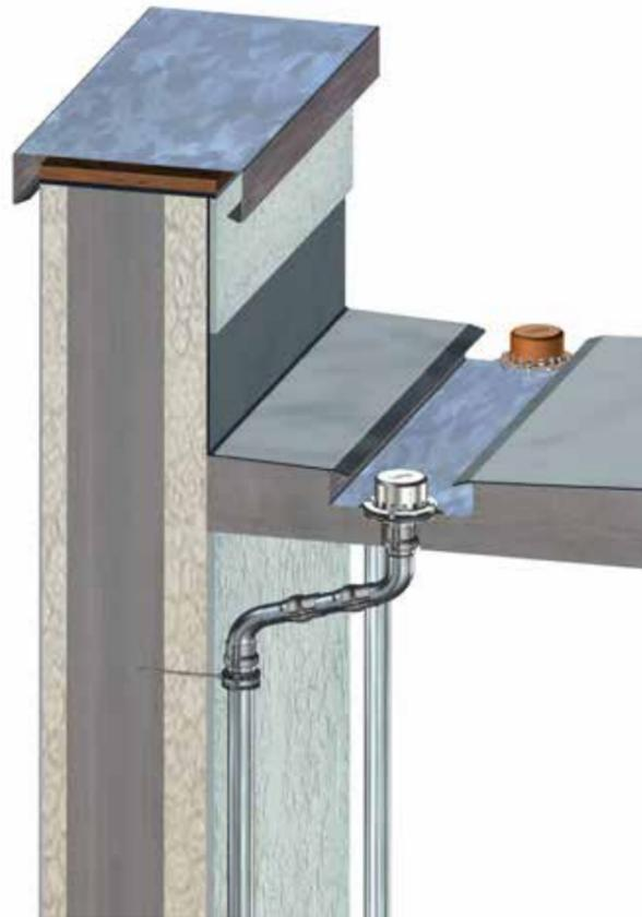
Beispiel: gedämmte, metallische Kastenrinne mit zweiteiligem DRAINJET-Mini Ablauf.
